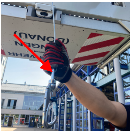
Um die Blockierfunktion des HSG zu überprüfen über halb des Sturzindikators / Wirbel fassen und ruckartig ziehen
