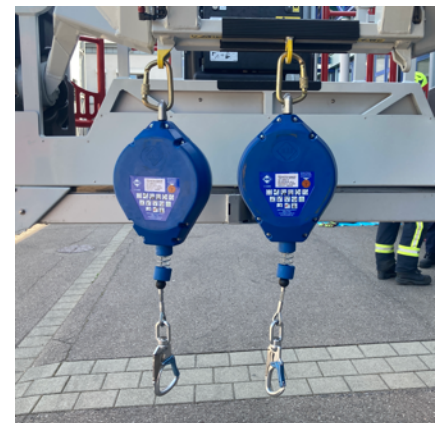
Wenn erforderlich können auch zwei HSG angeschlagen werden (jew. in gelber Öse)
