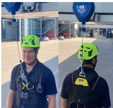
Auffangöse (Kennzeichnung mit "A") am Gurt vorne oder hinten
